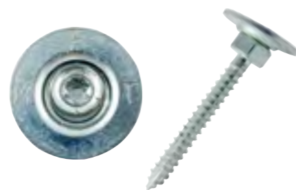
Nivåskruvens brickhuvud är självnivellerande upp till 5°, vilket gör justering av karm enklare vid fönstermontage.
